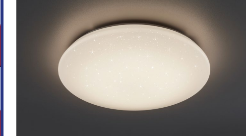
PLAFONIERA LED "FUJI" DIFFUSORE METACRILATO BIANCO EFFETTO CIELO STELLATO CON TELECOMANDO CON FUNZIONI DI VARIAZIONE LUCE CALDA E FREDDA, REGOLAZIONE INTENSITA' DI LUCE E LUCE NOTTURNA DIAMETRO 74CM SMD LED 40W, DA 3.000K A 5.500K, 4.650Lumen
